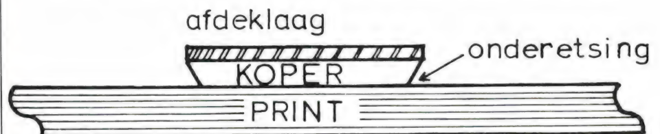
Afbeelding 3. Bij te hoge etstemperatuur of bij te lang etsen treedt er onderetsing op.
